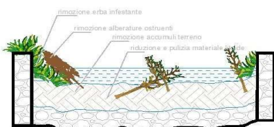
Schema tipologico situazione vasca laminazione "tipo" – PRIMA e DOPO gli interventi
